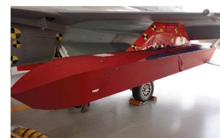
시험은 시험용 FA-50 전투기에 분리탄을 탑재해 진행됐다. 지난 4월부터 약 3개월 동안 31소티(출격)를 통해 △플러터 △조종 안전성 △하중 △항공전자 △환경시험 등 항공기 연동 비행시험을 한 후 시행했다. 2027년부터는 KF-21 전투기 시제기에 탑재해 후속 개발시험 및 운용시험평가를 수행하며 작전운용성능을 검증할 예정이다.
